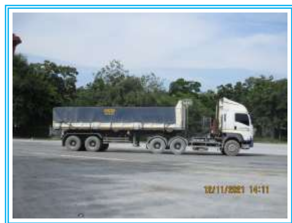
รูปที่ 3-52 ปิดคลุมรถบรรทุกแร่ด้วยผ้าใบมิดชิด
