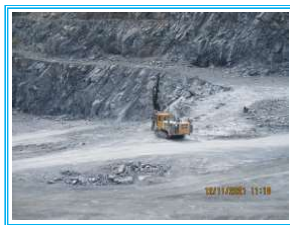
รูปที่ 3-20 เครื่องเจาะระเบิดที่มีอุปกรณ์เก็บฝุ่น
