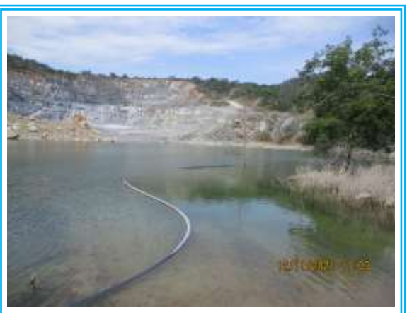
รูปที่ 3-11 บ่อดักตะกอน (Sump)
