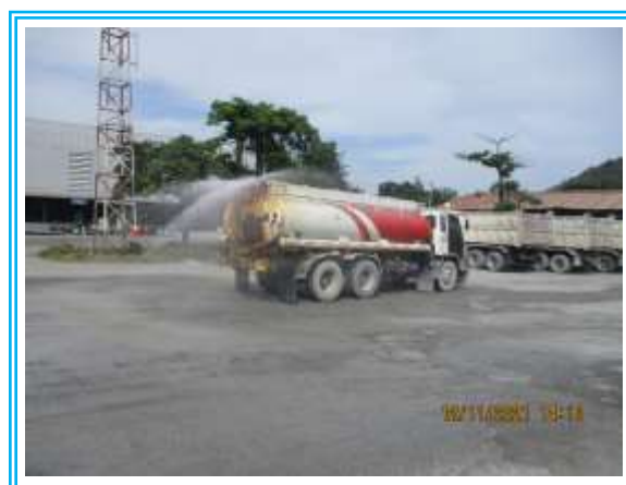
รูปที่ 3-24 ฉีดพรมน้ำเส้นทางขนส่งแร่ภายในโรงโม่
