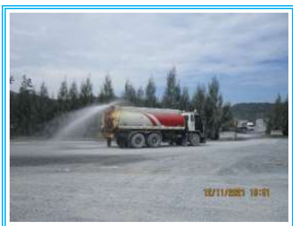
รูปที่ 3-23 ฉีดพรมน้ำเส้นทางขนส่งแร่ภายในโรงโม่
