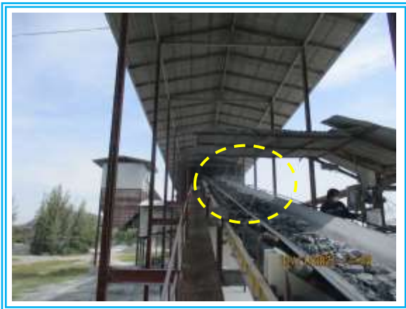
รูปที่ 3-39 ระบบสเปรย์น้ำปลายสายพานลำเลียง
