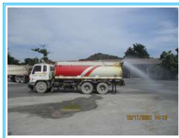
รูปที่ 3-22 ฉีดพรมน้ำเส้นทางขนส่งแร่หน้าเหมืองถึงโรงโม่
